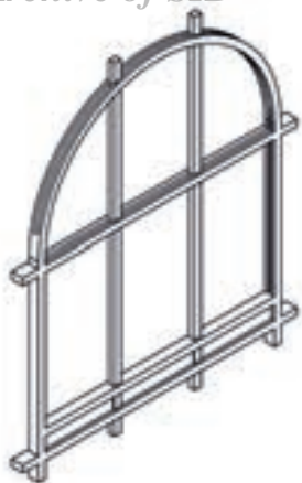
تصویر ۱۹: طرح یک چهارچوب اُرسی سه لته (سه لنگه) که در محل نصب می‌گردد (ترسیم: محمدیان منصور).
