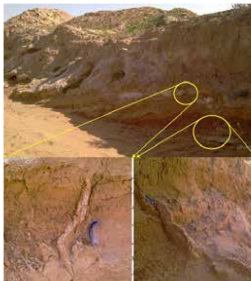
تصویر ۲: نمایی از درزه‌های قائم در محدوده معبد چغازنبیل با راستای شمال غربی- جنوب شرقی. در این بخش، پرشدگی درزه‌ها به وسیله رگه‌های گچ کاملاً مشهود است.
