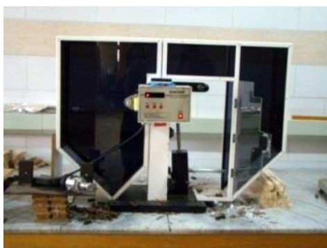
تصویر ۳۸. دستگاه SANTAM برای سنجش مقاومت به ضربه
