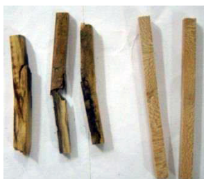
تصویر ۲۹. بررسی ظاهری تحمل نمونه‌ها در محاسبه مقاومت خمشی
