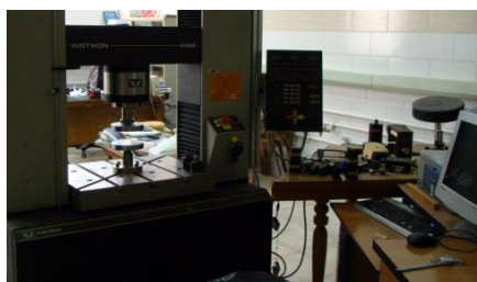
تصویر ۲۴. دستگاه INSTRON 4486 برای محاسبه مقاومت خمشی، فشاری و سختی گوی فلزی
