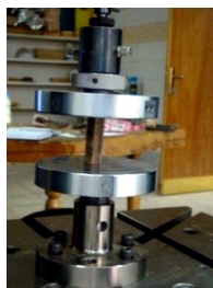
تصویر ۳۳. دستگاه محاسبه فشار موازی الیاف برای نمونه چوب ها
