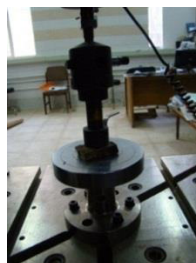
تصویر ۴۰. محاسبه مقاومت به سختی با گوی فلزی | تصویر ۴۱. بررسی ظاهری از میزان سختی
