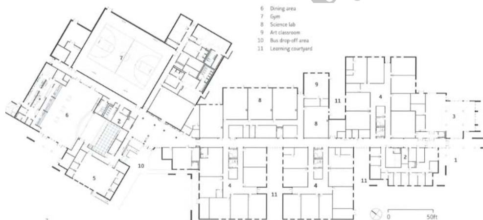
تصویر ۱۲. مدرسه وست برازوس جونیور، الگوی ۴ در چیدمان کلاس‌ها، الگوی ۲ در چیدمان فضای خدماتی و الگوی ۱ در فضای عطف اصلی (همان، ۲۱۴)
