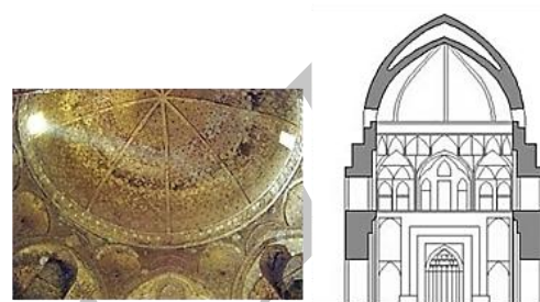
تصویر ۱۲: گنبد دو پوسته پیوسته مسجد برسیان اصفهان. مقطع گنبد (Ashkan, 2009, 105). و نمای زیر گنبد مسجد برسیان (www.shw.kousha.fotopages.com).
