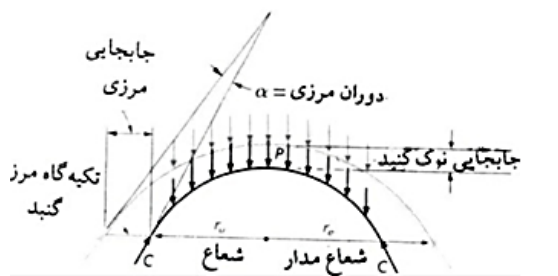
تصویر ۱: تغییر شکل گنبد کروی با خیز کم (سالوادوری، ۱۳۸۲، ۲۵۶)
