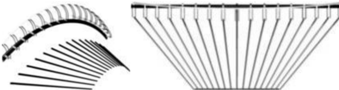
شکل ۷: راست: پلان سقف و میله های متحرک آن، چپ: نمای ۳ بعدی از استخوان بندی سازه ای و میله های طره ای متناظر آن (ترسیم: نگارندگان)
