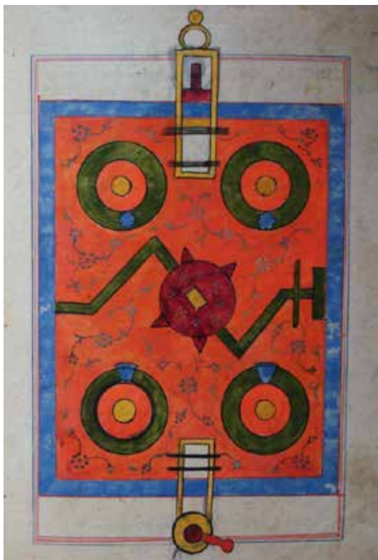
تصویر ۱۰. مصورسازی شکل اصلی دستگاه سوم از نوع اول کتاب جزری در نسخه ۷۰۸ کتابخانه دانشگاه شهید مطهری (مأخذ: نسخه خطی، برگ ۲۵۲)
