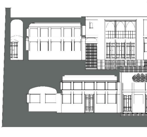
تصویر ۱- راست: مقطع فضای زیرزمینی زیر هفت دری (زمستان نشین) خانه رسولیان (دانشکده هنر و معماری دانشگاه یزد) تصویر ۱- چپ: مقطع گودال باغچه خانه لاری‌ها (دانشکده هنر و معماری دانشگاه یزد)
