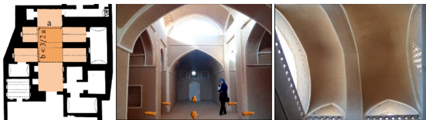
تصویر ۳: خانه شش صفه عبدالحسین فناء توحیدی؛ تناسب میانخانه یک خانه شش صفه (معماریان، ۱۳۹۱: ۴۱۰)
