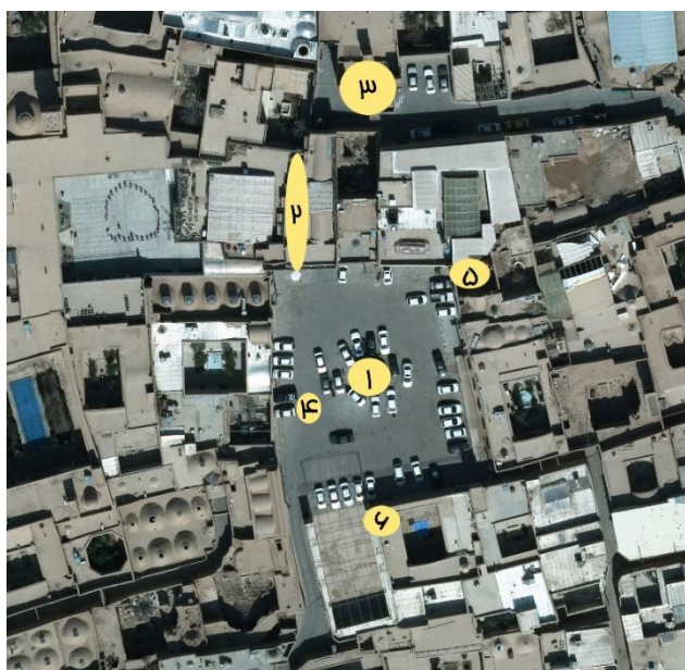
تصویر ۱۵- جانمایی کلی سازه‌های آبی تاریخی میدان وقت و ساعت بر روی عکس هوایی سال ۱۳۹۵-۱) پایاب قنات وقف‌آباد، ۲) آبانبار وقت و ساعت، ۳) مخزن و بادگیرهای آبانبار وقت و ساعت، ۴) محل ورودی پایاب شاخه شیرین قنات زارچ، ۵) پایاب آله‌آباد، ۶) چاه‌خانه ملک خجسته
