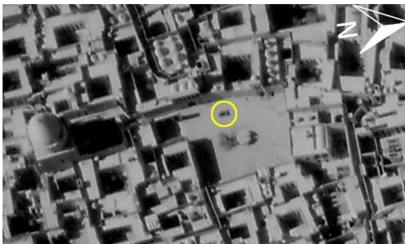
تصویر ۹- عکس هوایی از میدان وقت‌الساعت در سال ۱۳۴۳ (سازمان جغرافیای ارتش ایران)- در این تصویر ورودی پایاب قنات زارچ و دیوارچینی اطراف آن که سایه انداخته به خوبی دیده می‌شود و با دایره زرد مشخص شده است.
