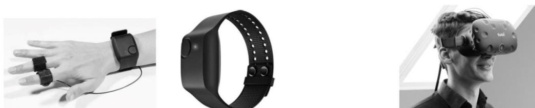
تصویر ۵- سمت راست؛ هدست واقعیت مجازی Tobii Pro VR Integration که قابلیت ردیابی حرکت سر و چشم (Head and Eye tracking) را دارد (www.tobiiipro.com). سمت چپ؛ ابزار Empatica E4 wristband که سطح هدایت پوستی (Skin Conductance) و ضربان قلب را ارزیابی می‌نماید (www.empatica.com).
