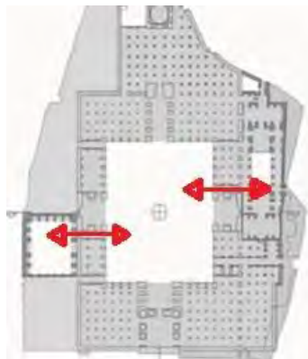
تصویر ۱۲؛ پلان مسجد جامع اصفهان قرن هشتم هجری (آل مظفر) و افزایش دسترسی به بیرون صحن اصلی، (مأخذ؛ جبل عاملی، ۱۳۹۲: ۵۱)
