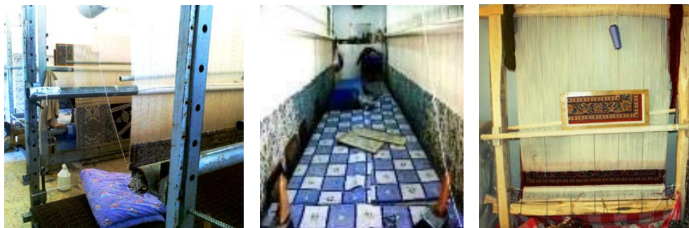
تصویر ۲: مقایسه دارهای قالی‌بافی در فرش نایین: (راست) دار چوبی، (وسط و چپ) دار آهنی برای تولید فرش‌های بزرگ در مکان‌های جدید (نگارنده).
