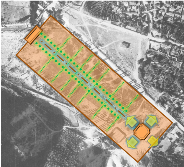
تصویر ۶. تحلیل پلان باغ چشمه‌عمار؛ هندسه مستطیلی، محور عمیق و تراس‌بندی باغ، استقرار عمارت چهارایوانی در بالاترین نقطه باغ، چشم‌انداز عمیق داخلی و وسیع بیرونی از عمارت. مأخذ: نگارندگان.
