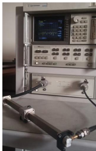
شکل (۱۴) سامانه اندازه‌گیری موجبری برای ماده غیرهمگن [۳۸]
