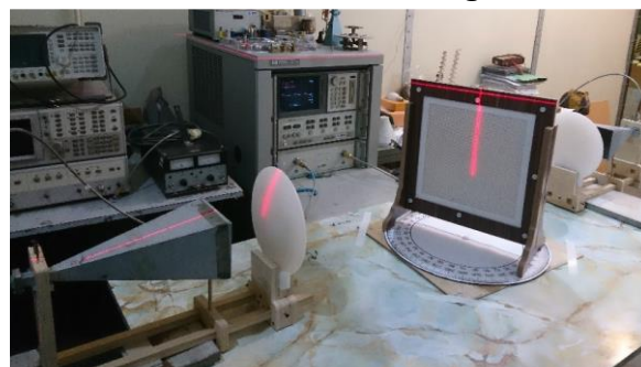
شکل (۱۲) سامانه اندازه‌گیری فضای آزاد برای ماده غیرهمگن [۲۸]
