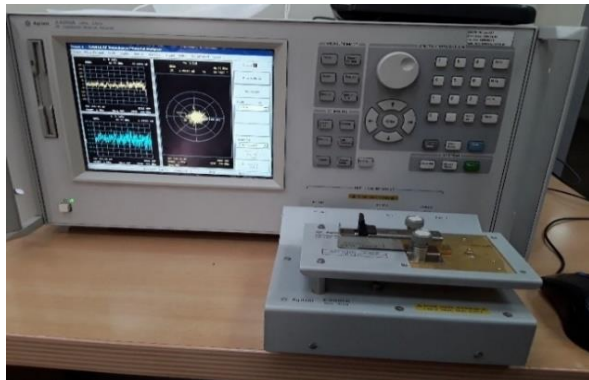
شکل ۲- امپدانس آنالایزر مدل Agilent E4991A و نگهدارنده مدل Agilent 16192A.
