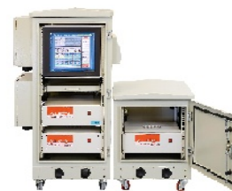
الف) اندازه‌گیری I-V و توان بیشینه خرید خارج UL 1704 clause 20 IEC 61215 clause 10-2 IEC 61646 clause 10-2
