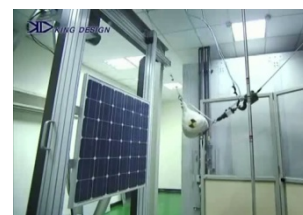
آزمون شکستن مدول خرید خارج/ساخت داخل IEC 61730-2 clause 10.10
