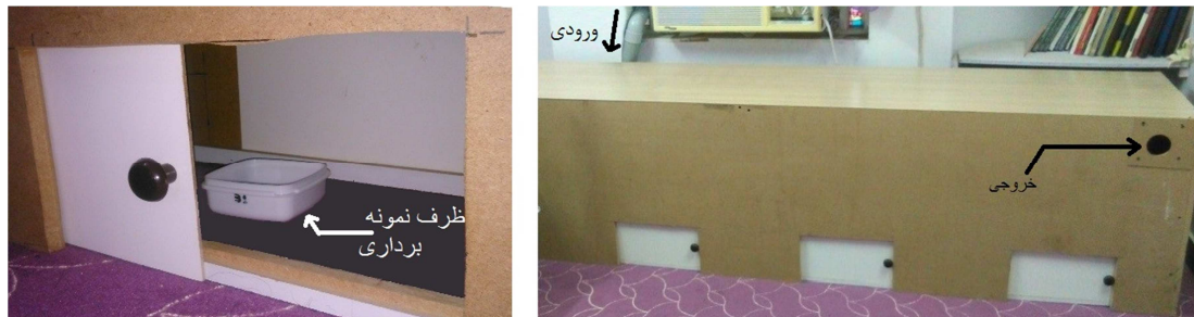
شکل ۳ سمت راست: نمایی از اتاقک سکون واقع در اتاق. سمت چپ: جای گذاری ظرف نمونه‌برداری
