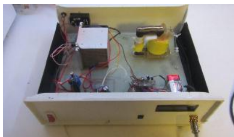
شکل ۷- نمای خارجی از واحد ولتاژ بالای طراحی شده
