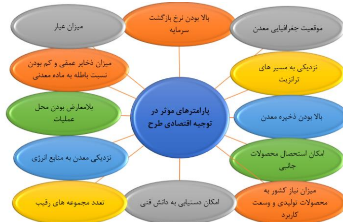
شکل ۴- برخی از پارامترهای موثر در توجیه اقتصادی یک طرح فرآوری مواد معدنی [۱]
