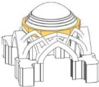
شکل ۱۶- قرارگیری گنبد مسجد بر روی قوس‌های باربر (هوشیاری و فرشته‌نژاد، ۱۳۹۲: ۷).
