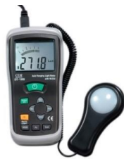
شکل ۸- تصویری از لوکس سنج مورد استفاده در اندازه گیری های میدانی (مآخذ: نگارنده)
