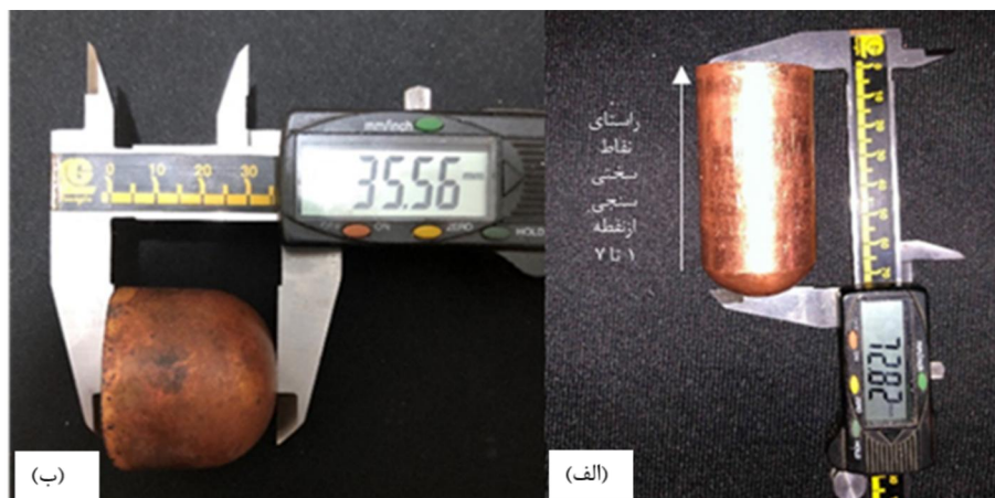
شکل ۳ الف) نمونه نهایی پس از فرآیند اتوکشی محدود شده (راستای سختی سنجی در تصویر مشخص شده است که نقاط ۱ تا ۷ به ترتیب از پایین تا بالای پوسته تعیین گردیده‌اند)، ب) فنجان کشش عمیق شده
