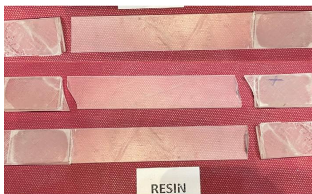
شکل ۱۷ شکست نمونه‌های رزین خالص در آزمون کشش
