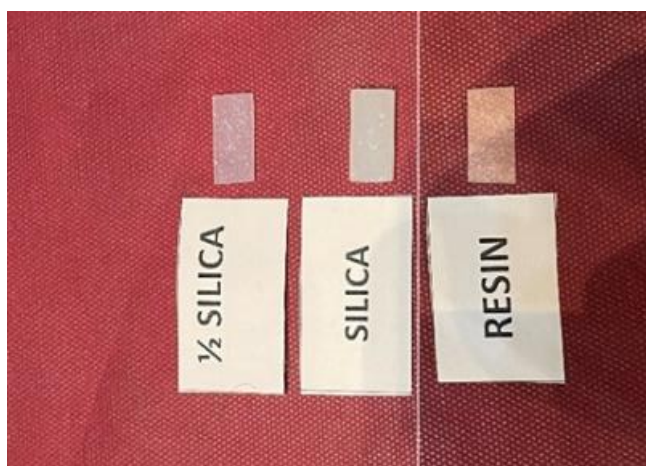
شکل ۱۱ نمونه‌های برش داده شده برای تست دی‌الکتریک
