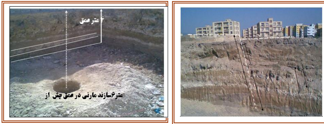
تصویر (۳) مواد آتشفشانی دارای میکرو گسل‌های فعال و ساخت و سازه‌های در معرض خطر تصویر (۴) وجود سازند مارنی و آهکی در سطوح شیبدار در مواقع زمین لرزه مخاطره آمیز هست (منبع: نگارندگان)
