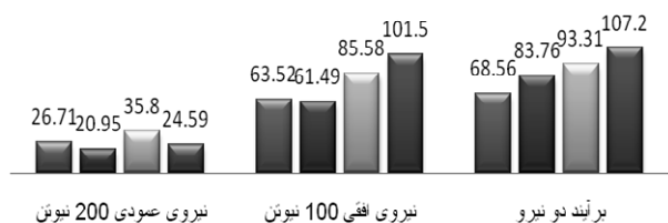
نمودار ۱. بیشترین میزان تنش معادل بر حسب مگاپاسکال در سطح باکال استخوان در ناحیه کروئال به تفکیک نیروهای وارده و سیستم ایمپلنت‌های مورد بررسی
