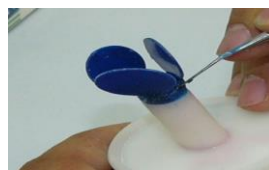
شکل ۳- تصویر تهیه‌ی الگوی مومی و اسپروگذاری دیسک‌های مومی ساخته شده
