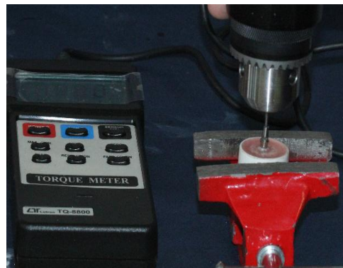
شکل ۱- دستگاه تورکمتر الکتریکی جهت وارد کرن نیروی تورک نهایی و اندازه گیری RTV
