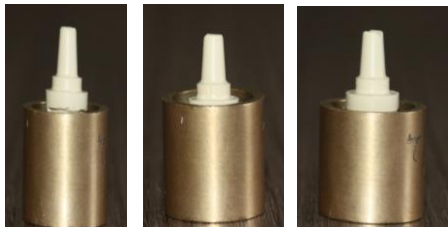
شکل ۱- دای‌های PEEK تهیه شده با CAD-CAM بر روی پایه فلزی (از راست به چپ: چمفر، اسلوپ شولدر، شولدر)
