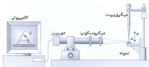
شکل ۱- شیوه اندازه گیری زاویه تماس
