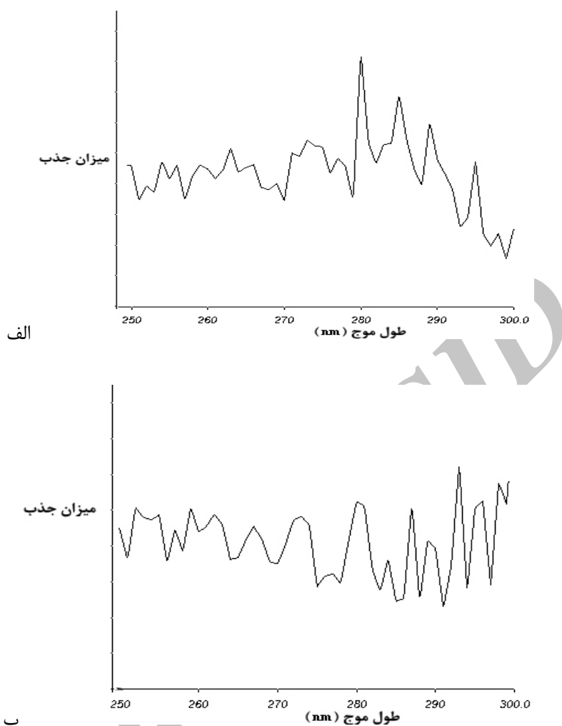
شکل ۴- طیف‌سنجی عصاره استخراج شده از خمیر کاغذ- نمونه شاهد (الف) نمونه تیمار شده با آنزیم (ب)
