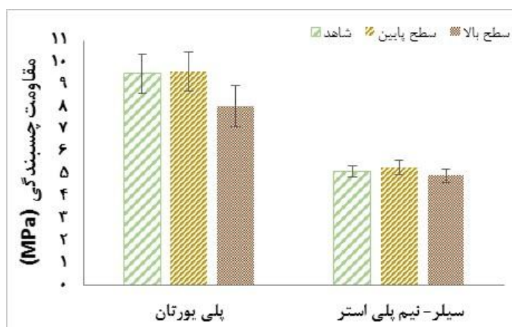
شکل ۲- اثر متقابل میزان فورفوریل‌اسیون و نوع رنگ بر مقاومت چسبندگی پوشش در چوب راش (Pull-Off)
