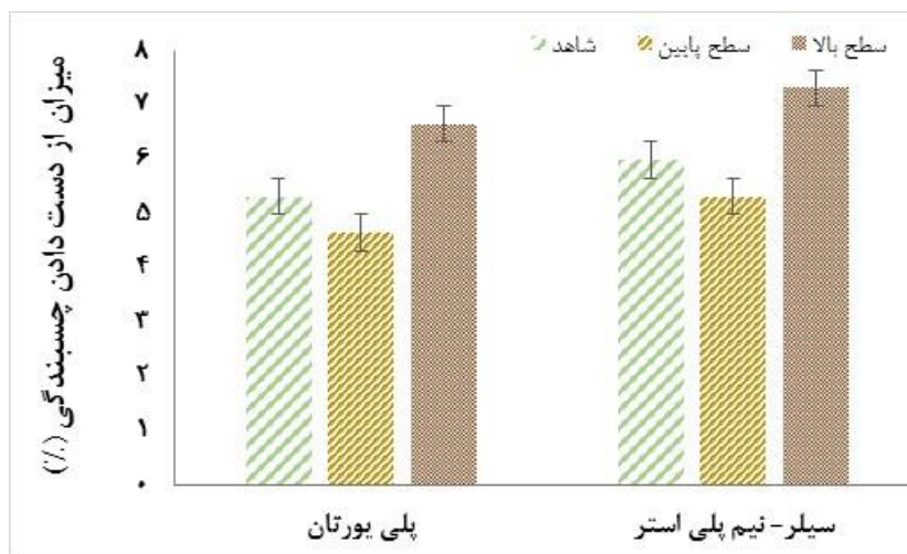
شکل ۳- اثر متقابل میزان فورفوریل‌اسیون و نوع رنگ بر مقاومت چسبندگی پوشش در چوب راش (Cross-Cut)
