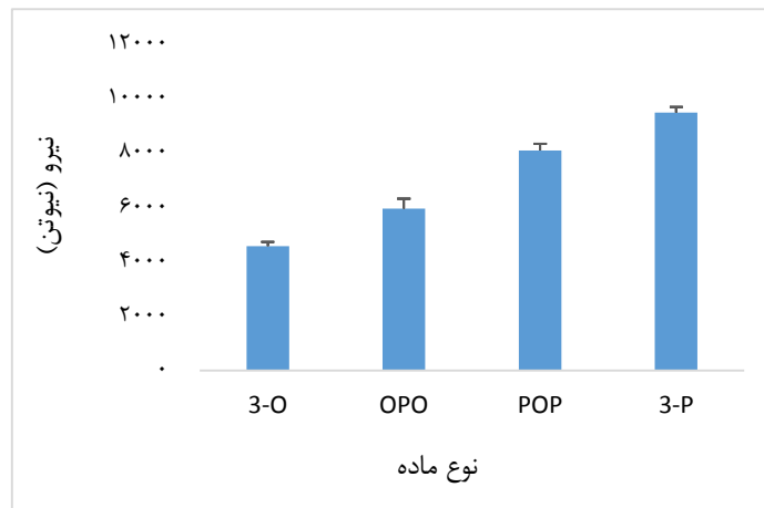
شکل ۶- اثر مستقل نوع ترکیب ماده مهندسی شده چوب بر پارامتر حداکثر نیروی جابجایی اتصال دهنده
