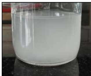
شکل ۴ - سوسپانسیون نانو الیاف سلولزی در آب
