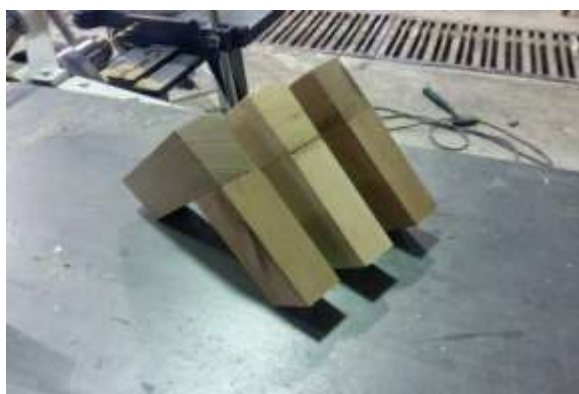
شکل ۱- نمایی از نمونه‌های آزمون ساخته شده برای بررسی ظرفیت لنگر خمشی اتصال با پین
