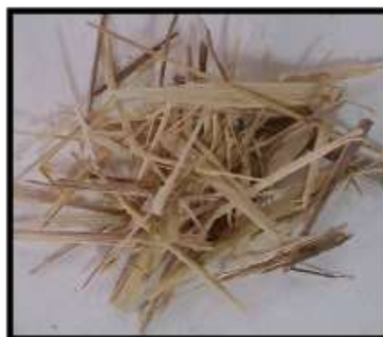
شکل ۱- تراشه‌های تولید شده به وسیله‌ی آسیاب رینگی پالمن
