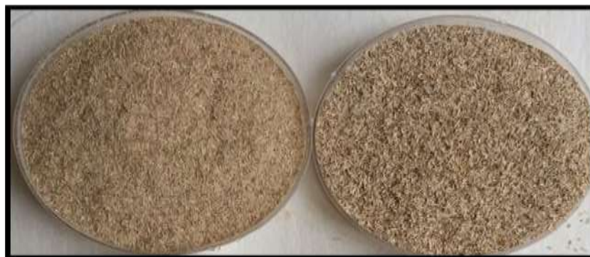
شکل ۲- آرد بامبو در دو اندازه مش ۶۰ (راست) و ۸۰ (چپ)
