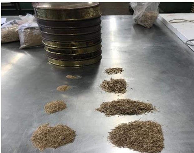
شکل ۴- دانه‌بندی ذرات پس از آسیاب با الک آزمایشگاهی
