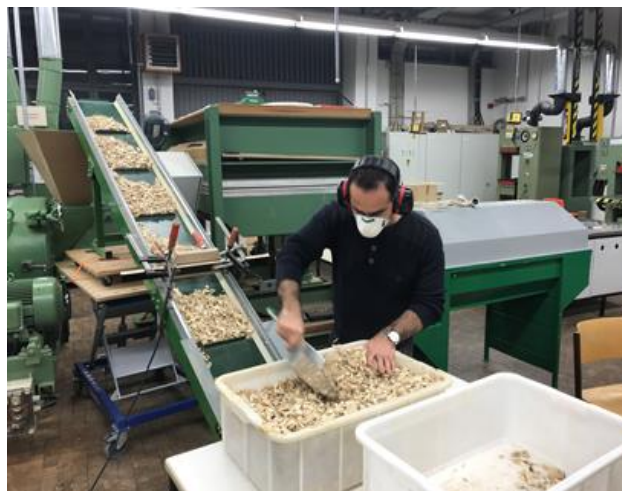
شکل ۳- تغذیه آسیاب تیغه‌ای با نوار نقاله
