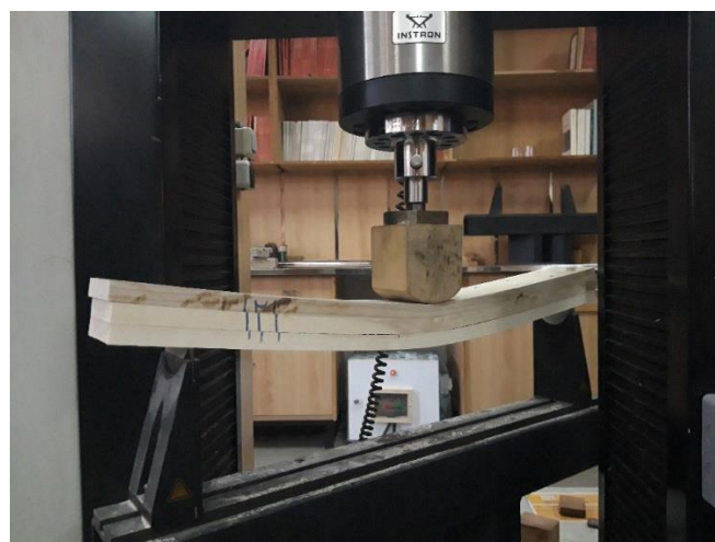
شکل ۲- آزمون خمش روی گلولام
