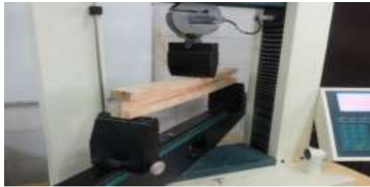
شکل ۳- آزمون تعیین مقاومت خمشی تیر I شکل
