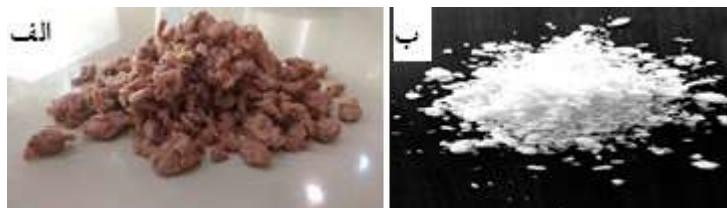
شکل ۲: تصاویر خمیرهای رنگبری نشده (الف) و رنگبری شده (ب) کاه گندم
