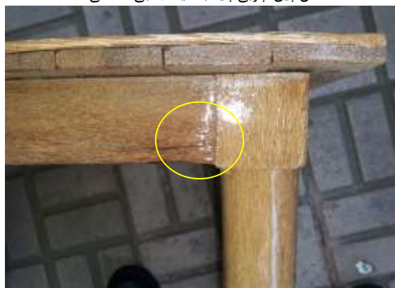
اتصال بین چوبی پایه به قید جانبی میز
