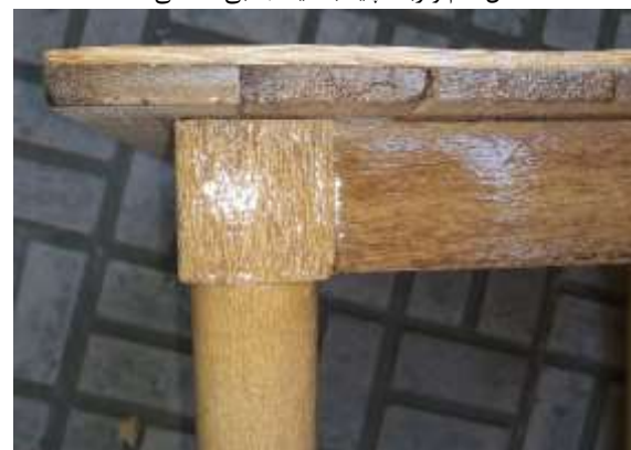
اتصال کام و زبانه پایه به قید جانبی میز
