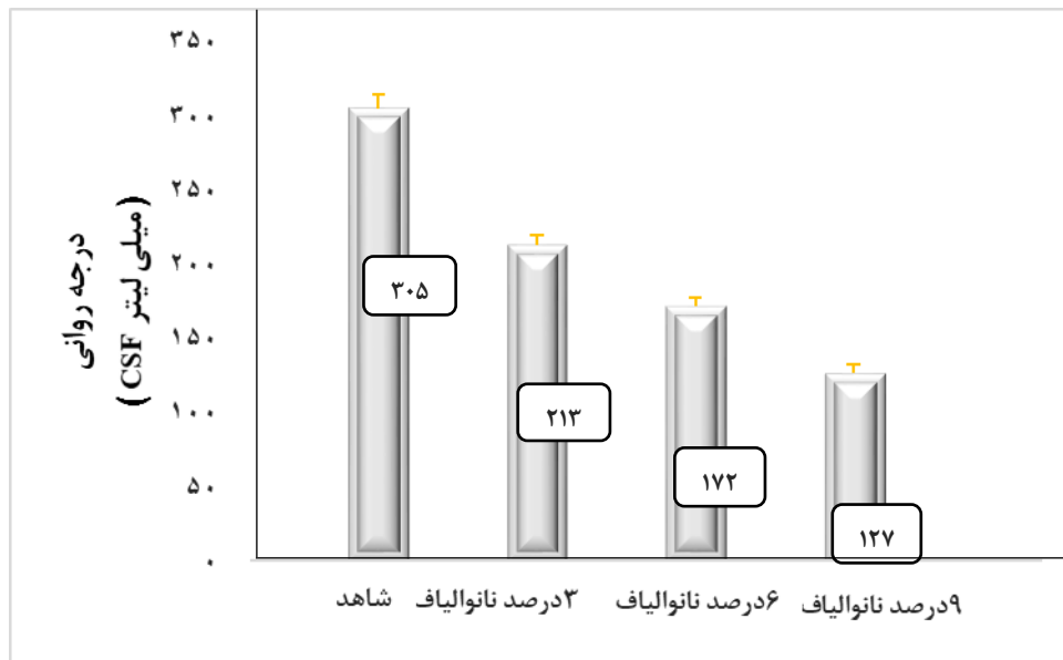
شکل-۴ تأثیر تیمارهای اعمال شده بر میزان آبدگیری از خمیر کاغذ
