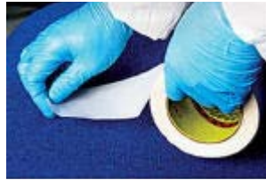
شکل ۱: جمع کردن الیاف به وسیله نوار چسب
