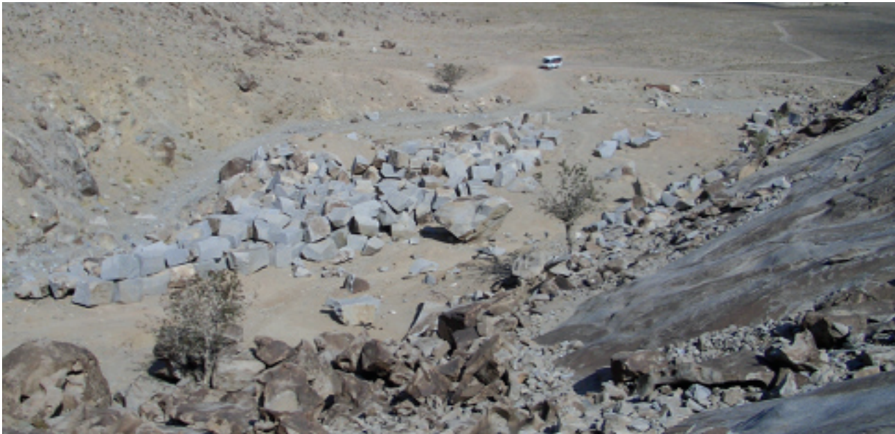
تصویر ۱- معدن گرانیت لوچان واقع در جنوب غربی زاهدان. بلوک های سالم و غیر هوازده، هر یک به ابعاد حدودی ۲×۲ متر برای تهیه پلاک به کارخانجات سنگ بری ارسال می گردند.
