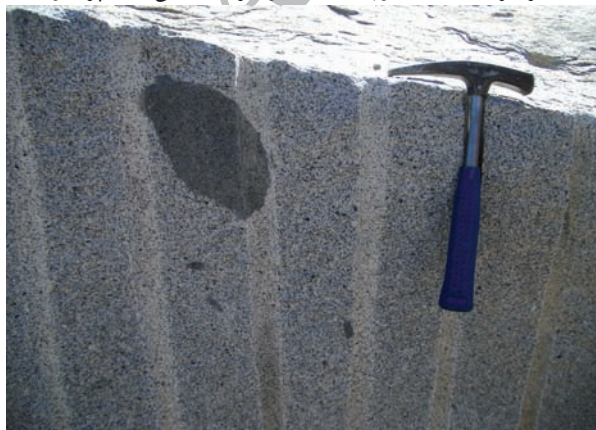
تصویر ۷- وجود انکلاوها در سنگ گرانیت از نظر معدن چیان و تجار سنگ عیب و نقص تلقی می شود. چنین سنگ های گرانیتی را سرطانی می نامند.
