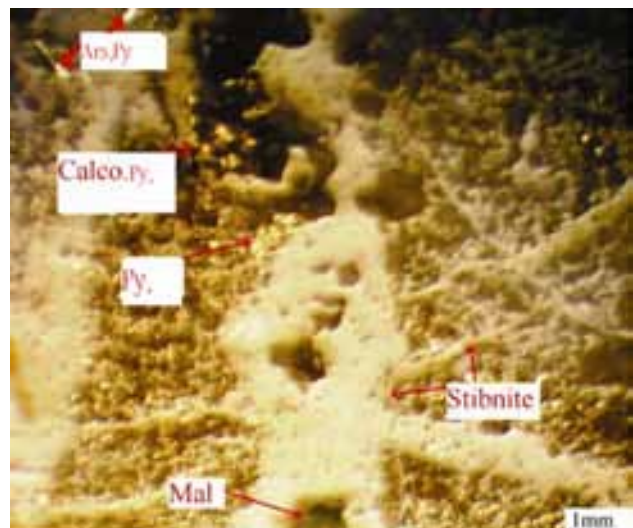
تصویر ۴- نمونه‌ی S.CH-W4-S3: بلورهای پیریت و کالکوپیریت به صورت پراکنده و پرکننده‌ی فضای خالی، به همراه بلور لوزی‌شکل آرسنوپیریت (بالا، سمت چپ) و مالاکیت که در بین بلورهای استیبینیت جای گرفته است. چاهک شماره‌ی ۴ (نور انعکاسی، بدون فیلتر نورآبی، (XPL) 10×20
