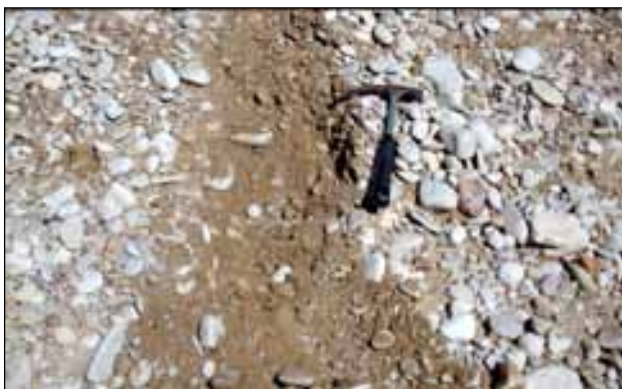
تصویر ۱۱- نمایی از دانه‌بندی رسوب در کف مسیل منتهی به سد میرزای شیرازی
