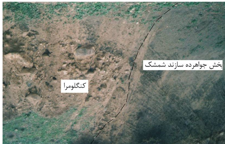
تصویر ۵- مرز کنتاکت تکتونیزه بخش جواهرده سازند شمشک با رسوبات کنگلومرای توده‌ای
