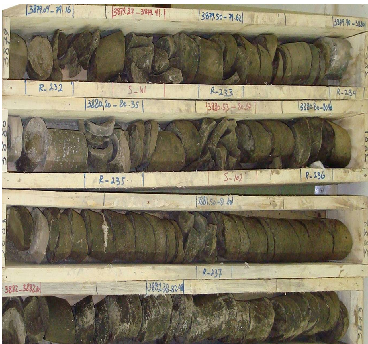
تصویر ۱۰- پهنه شکستگی‌های پشت سر هم در یک زون (Fractures Zone)، شکستگی‌های رهایی (Reales Fractures) و آثار نفت (رنگ تیره)
