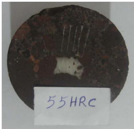
تصویر ۱۰- نمایی از نمونه‌ها پس از ایجاد خراش در آزمایش سرشار با دو پین مختلف
