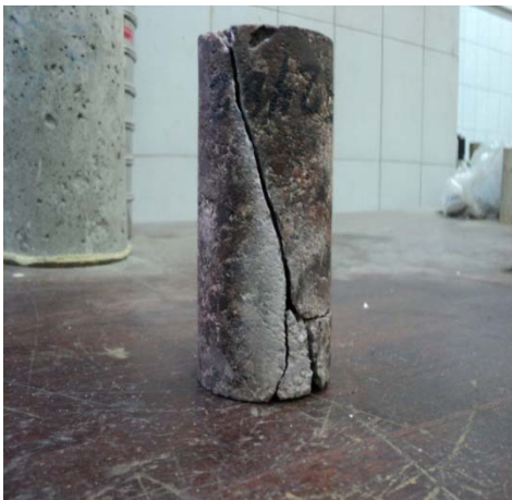
تصویر ۶- شکست برشی در یکی از نمونه‌ها پس از بارگذاری
