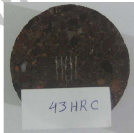
تصویر ۱۰- نمایی از نمونه‌ها پس از ایجاد خراش در آزمایش سرشار با دو پین مختلف
