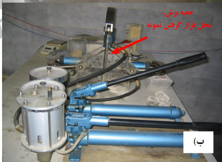
تصویر ۱- آزمایش برش مستقیم بر روی نمونه سنگی، (الف) آماده‌سازی نمونه‌ها برای آزمایش، (ب) دستگاه آزمایش برش مستقیم و چگونگی اعمال نیرو
